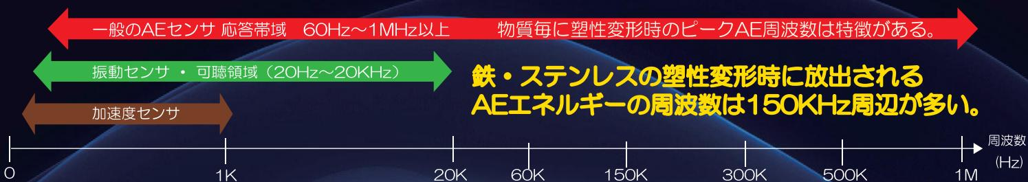
Early Observerの「対象物質別AEセンサ」で鉄・ステンレスの塑性変形を監視
